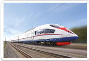
Görsel 1.56 Hızlı tren gibi ulaşım araçlarında, hava sürtünmesinin en aza indirilmesi için gerekli tasarımlar yapılır.
