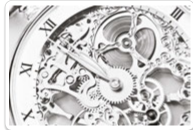
Görsel 1.138 Mekanik saat içinde kullanılan farklı çaplara sahip dişliler sayesinde saat ibrelerinin dönüş hızları ayarlanabilir.
