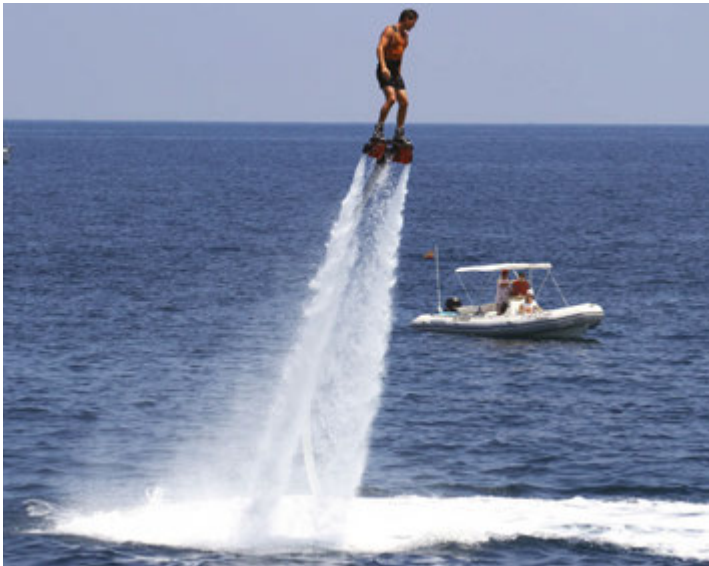
Görsel 1.37 Bir deniz eğlence aracı olan flyboard, suyu geriye itmesi ile oluşan tepki kuvveti sayesinde yükselir.
