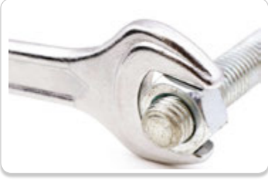
Görsel 1.111 Kuvvetin döndürme etkisi kullanılarak vida anahtarı ile bir civatayı söküp takabiliriz.
