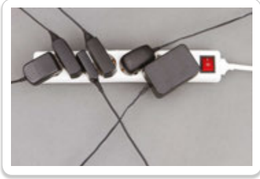
Görsel 2.34 Şarj cihazlarının ya da adaptörlerin içindeki transformatörler istenilen gerilimin elde edilmesini sağlar.
