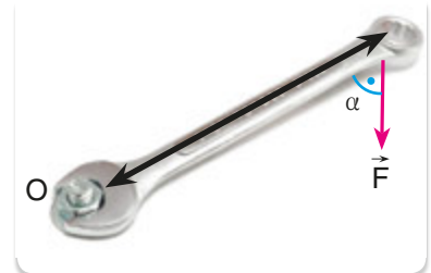
Görsel 1.119 Kuvvetin, kuvvet koluna dik olmadığı durumlarda torku bulmak için iki yöntem kullanılabilir.
