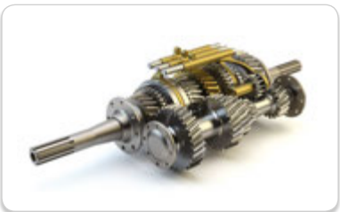
Görsel 1.144 Vites kutusunda bulunan farklı büyüklükteki dişli çarklar sayesinde arabanın istenilen hızda gitmesi sağlanır.
