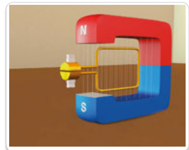
Şekil 2.75 Manyetik alan, tel çerçeve düzlemine paralel olduğu yani \theta = \omega t = 0^\circ veya 180^\circ olduğu anda indüksiyon emk minimum değerini alır.
