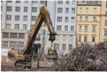
Görsel 2.24 Hurdalıkta kullanılan vinçler, akım makarasının mıknatıs özelliğinden faydalanılarak yapılır.
