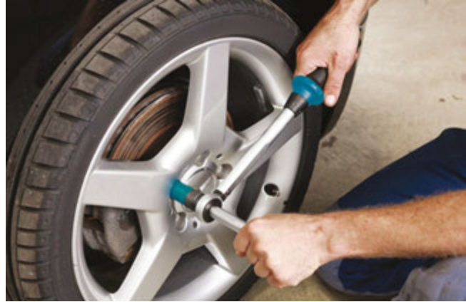
Görsel 1.118 Güvenlik için torkmetre kullanılarak sıkılan tekerlek civataları
