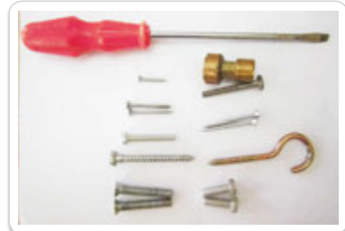
Görsel 1.137 Vidalar ve bu vidaları söküp takmaya yarayan tornavidalar basit makinelerdendir.
