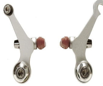
Görsel 4.49.b. Cantilever fren sistemi
