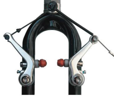
Görsel 4.49.a. Cantilever fren sistemi
