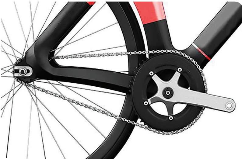
Görsel 2.20.a. Pedal ve fix dişli bölümü
