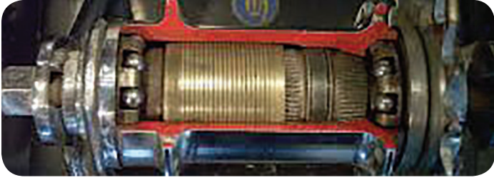
Görsel 1.14.b. Vites ve kontra pedal sistemi
