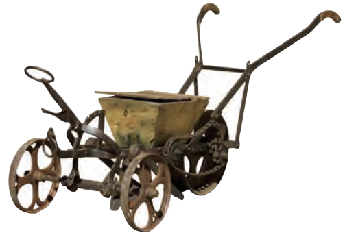
Görsel 5.5: Mekanik tohum ekme makinesi
