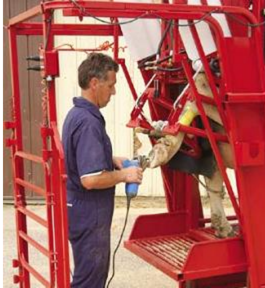
Resim 1.13: Elektrik ve hidrolik sistemli travay içerisinde arka bacağın tutulması
